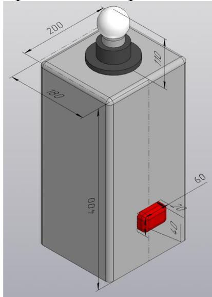
Рисунок 11. Схематическое изображение сигнального маяка
