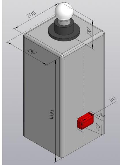
Рисунок 11. Схематическое изображение сигнального маячка
